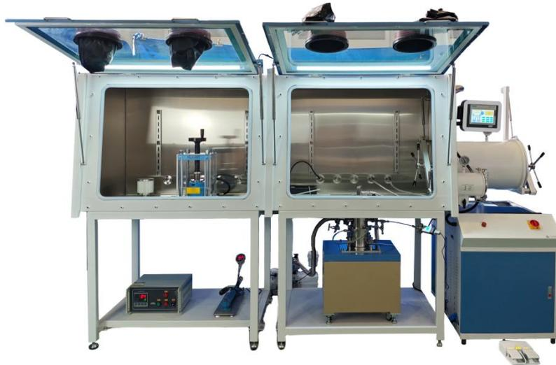
VBF-1100X-VGB 是一款已通过 CE 认证的立式管式炉。炉衬使用真空成型高纯氧化铝聚轻材料，采用电阻丝为加热元件。能够实现在真空或气氛保护条件下对样品快速升降温，方便客户对特殊材料的装载、烧制和观察。50 段可编程温度控制器，控温精度 $\pm 1^{\circ}\text{C}$ 。控制盒配有智能温度调节仪、控制电源开关、启动/停止按钮、工作状态指示灯，以便随时观察本系统的工作状态。配合手套箱使用，结合除水剂使得手套箱内的水氧含量可以达到 1ppm，可为实验创造一个无水无氧的洁净环境。手套箱设计为开启式，客户操作会更加容易和方便。被广泛的用于制备纳米材料、锂离子电池、催化剂和金属有机物等。
