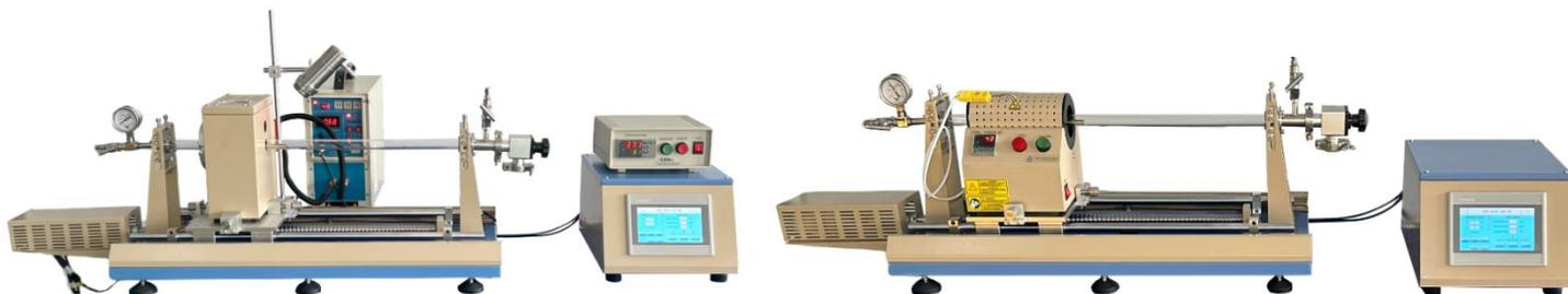
区域熔炼炉 OTF-400X-IDH-ZM 如图所示，是一款多种方法操作的区域炉，安装有双向导柱滑轨与电机控制部分，一个平台固定在移动机构上，用于放置感应加热系统和加热炉，通过触摸屏来设置移动距离和移动速度以及加热炉的升温程序，炉管使用石英管，石英管具有很高的耐急冷急热性，能满足突然降温而不破裂的要求；石英管横穿于炉体中间作为的炉膛，炉管两端用不锈钢法兰密封，实验样片在管中加热。使用感应加热系统和测温装置时，可通过红外测温仪测量到实验所要求的温度。且感应加热系统左边安装了一个风刀，风刀可打开，可随炉体左右移动。风刀的进气口通过气管串联在一起。
