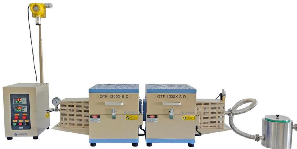
OTF-1200X-S-D 是一款小型双温区连体式可开启管式炉，其最高工作温度可达 1200℃，此款管式炉的炉管为高纯石英管，其直径为 80mm。配有一套不锈钢密封法兰，样品可在真空状态或气氛保护状态下进行热处理。管式炉拥有两个加热长度为 200mm 的加热区，两个温控系统分别独立控制两个温区，都可设置 50 段升温程序，控温精度为  $\pm 1^{\circ}\text{C}$ 。（图片仅供参考，请以实物为准）
