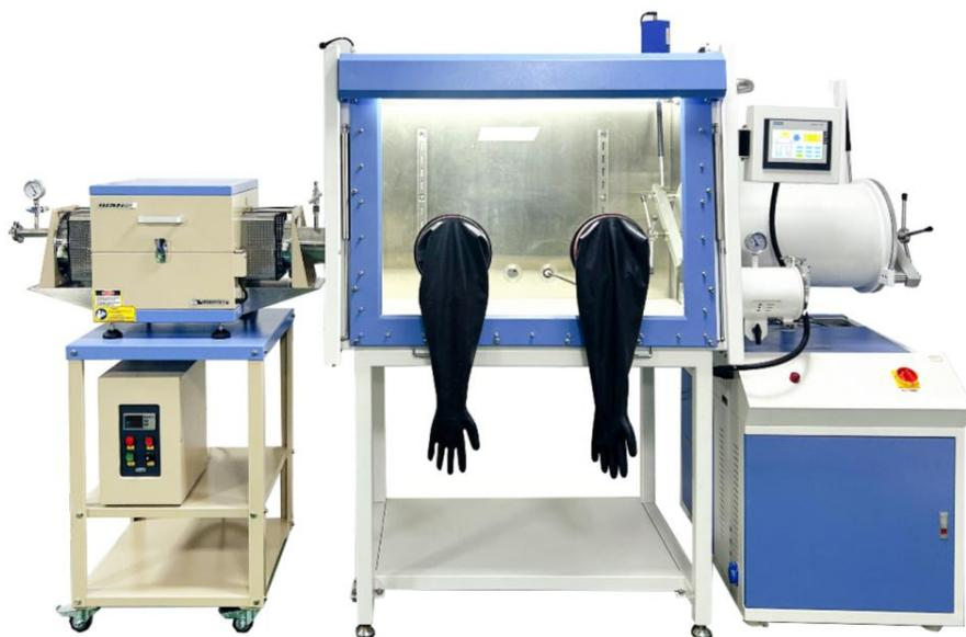
OTF-1200X-5S-VGB 是一款可与手套箱组合起来的高温管式炉。炉衬使用真空成型高纯氧化铝聚轻材料，采用电阻丝为加热元件，炉管两端用不锈钢法兰密封。采用风冷冷却，具有快速升降温特点。测温采用性能稳定，长寿命的“K”型热电偶，以提高控温的精准性。它是专为高等院校、科研院所及工矿企业对金属、非金属及其它化合物材料的烧结、融化、淬火而研制的专用设备。此款设备中高温炉的炉管与循环手套箱连接，将样品处理后可直接移入到气氛保护环境下的手套箱中。
