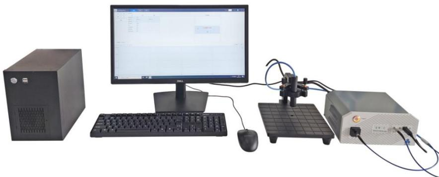
本设备利用反射干涉的原理进行无损测量，测量吸收或者透明衬底上薄膜的厚度以及折射率，同时提供样品反射率，测量精度达到埃级的分辨率，测量迅速，操作简单，界面友好，测量时间不到 1 秒。可应用于光阻、半导体材料、高分子材料等薄膜层的厚度测量，在半导体、太阳能、液晶面板和光学行业以及科研院所和高校都得到了广泛的应用。
