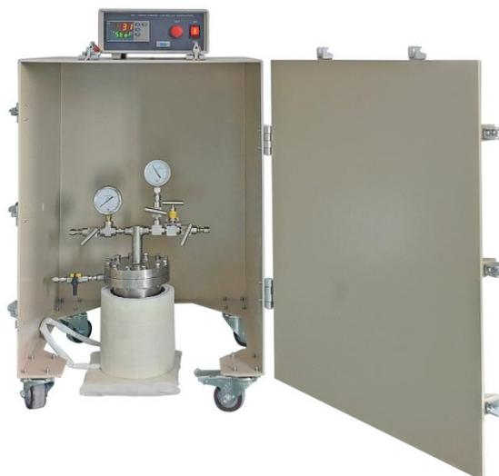
此款钛反应釜系统是一款由纯钛金属制成的小型反应器, 拥有一定的抗腐蚀能力, 最大压力可达到 3MPa。配备真空吸液接口, 可以根据罐体内真空度控制进液量。可以应用于固液气相分步反应、多孔材料的自吸附真空浸渍等种复杂工艺过程。测温采用性能稳定, 长寿命的“K”型热电偶, 以提高控温的精准性。可以根据客户需求的尺寸进行定制。
