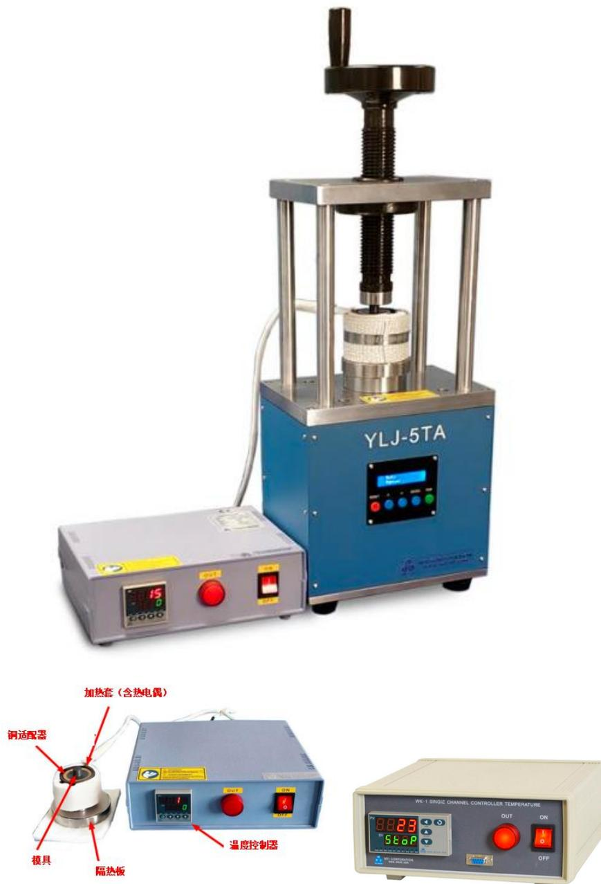
YLJ-HP2 是一款电动热压机，配有氮化硅模具，加热套（最高温度 550°C）和一个程序控制型电动压机（最大压力 5T）。可制备陶瓷，复合材料，和聚合物材料等样品。应用于包括微波电子材料，固态电解质和半导体等。这款小型的压机也适合在手套箱内使用，处理空气敏感性材料。
