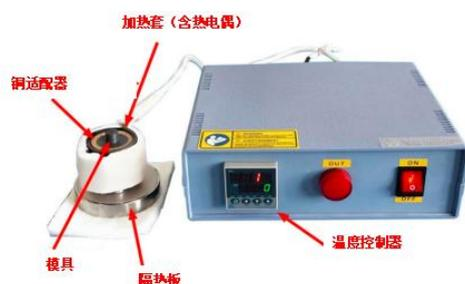
YLJ-HP2-H 是一款经济型的手动热压机，配有 12mm 内径的 Si3N4 模具，加热套（最高温度 550℃），温度控制器。可制备陶瓷，复合材料，和聚合物材料等样品。应用于包括微波电子材料，固态电解质和半导体等。
