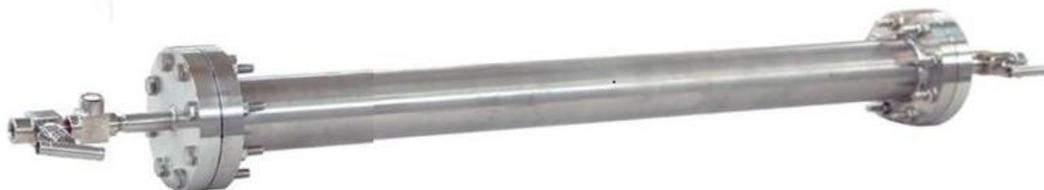
这是一款 SS304 不锈钢管，带有密封法兰和针阀，可在氧气，惰性气体或还原性气体环境下使用，最高温度可达 600℃。这一系列金属管可配合本公式管式炉使用，作为高真空管式炉或高温高压炉（HIP，热等静压）应用，炉管直径可选 25,38,50 和 76mm.
