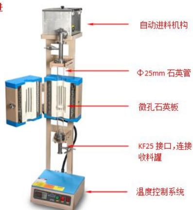
OTF-1200X-S-FB 是一款流化床立式炉, Φ25mm 石英炉管 (炉管中心区域直径为Φ50mm),用于粉末 CVD 实验 (FBCVD)。石英管中焊接一个微孔石英板,实验时样品粉末放置于微孔石英板上。微孔石英板上的微孔尺寸 15~40um,允许调节气流通过微孔石英板,使粉末在炉体加热区域悬浮起来,粉末和反应气体发生反应或沉积。
