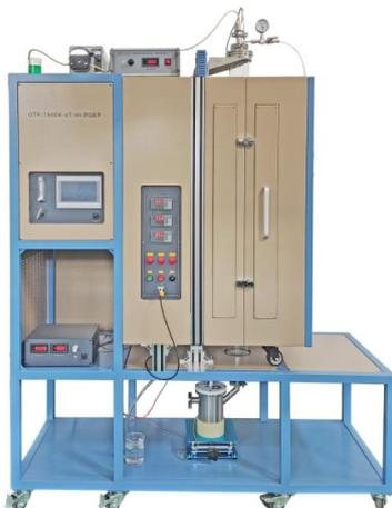
OTF-1500X-VT-III-PGEP 是一款多功能的合成系统，针对于合成各种纳米结构氧化物以及纳米材料的复合包覆工艺。此款仪器有三个主要模块组成：超声雾化装置、1500℃三温区立式管式炉和收集装置组成。材料制作大概分为三个步骤：前驱体雾化、加热和纳米颗粒收集。此款系统是一款非常先进的合成系统，可控制颗粒尺寸，形态，微纳米结构等，可广泛应用于纳米材料制备、电极材料包覆复合等方面。
