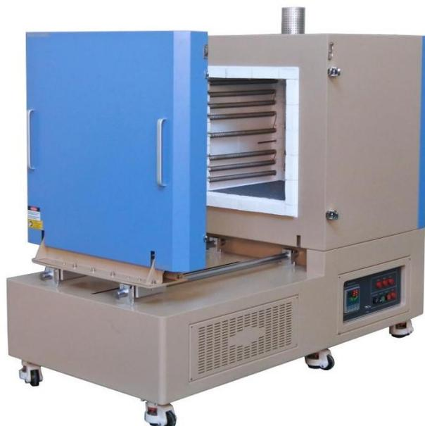
KSL-1200X-MAX-T 是一款五面加热的箱式炉，采用五个面加热能够保持温场较好的均匀性，炉门开启方式采用滑轨移动，炉门上装有样品台，其最高工作温度 1200℃。适合对金属及其它对温场要求均匀性较高的金属材料进行烧结、退火处理。此款设备可放入高温不锈钢金属盒，用于对各种陶瓷、多孔材料、3D 打印材料、金属材料等领域的退火、烧结、精细排胶、脱脂和材料烧结过程中的腐蚀和相互污染控制。电阻丝采用挂丝结构能够最大的提高温场均匀度和发热效率，且易于更换，对设备使用寿命和周期大大延长。
