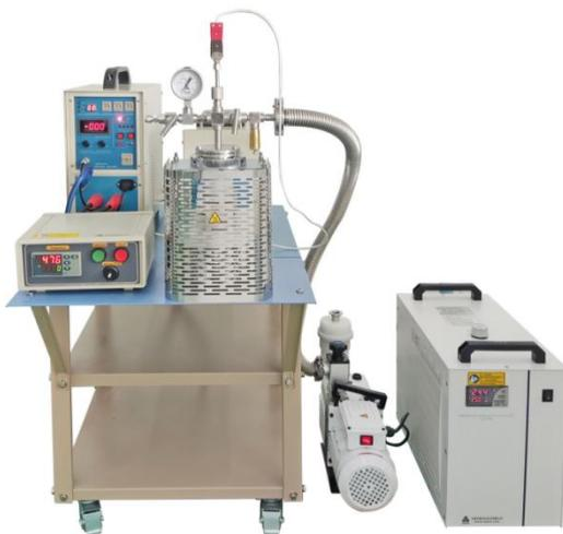
SP-15TC 型真空感应加热炉是一款小型的程控真空感应加热系统，他由加热系统、石英腔室（含不锈钢法兰），石墨坩埚、耐火材料、水冷机、真空泵以及其它的一些配件组成，它是一款研究金属材料（熔点 $\leq 1500$ 度、样品容积 $\leq 35\text{ml}$ ）的理想设备。
