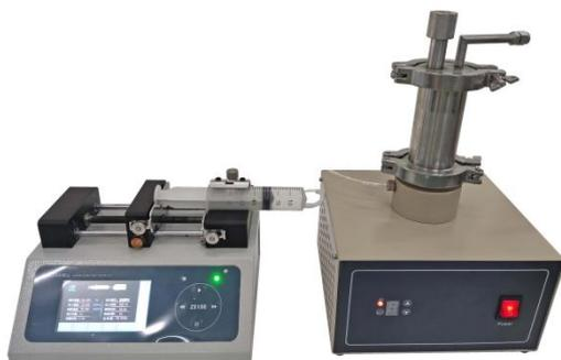
MSK-USP-G-LD 主要由注射泵和超声雾化装置组成，可将液体雾化成液体颗粒，导入到管式炉中，雾化档位可调，是一款操作方便且经济的设备。
